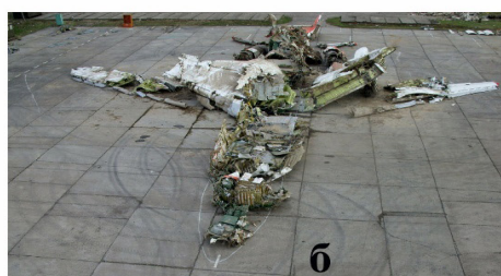
Рис. 6. Разрушение воздушного судна: а – разброс обломков при разрушении; б – карта разрушения
